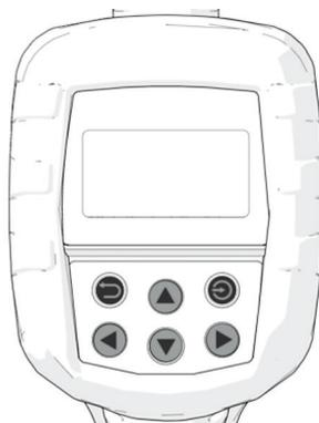
Le pistolet s'éteint automatiquement après 30 secondes d'inactivité pour économiser de l'énergie. Pour rallumer l'écran, appuyez sur l'une des touches UP/ DOWN. Une fois l'écran activé, le nom de l'équipement s'affiche un instant ainsi que la version du logiciel installé.
