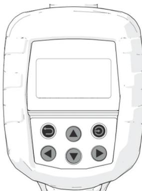
La pistola se apaga automáticamente trascurridos 30 segundos de inactividad para ahorrar energía. Para encender la pantalla de nuevo pulse cualquiera de las teclas ARRIBA/ABAJO. Una vez activada la pantalla, se muestra durante un instante el nombre del equipo junto con la
